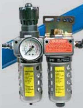
Блок сжатого воздуха состоит из фильтра с регулятором и лубрикатора. Верхним регулятором устанавливается давление (подача) сжатого воздуха. Для регулировки давления необходимо вытянуть регулятор. При повороте регулятора по часовой стрелке давление увеличивается, при повороте против часовой стрелки давление понижается. Во избежании случайной регулировки необходимо зафиксировать регулятор подачи воздуха.
