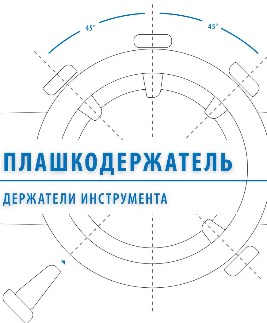
Плашкодержатели для плашек с диаметром 16 и 20 мм производятся с четырьмя упорными болтами, а плашкодержатели с наибольшим диаметром с пятью упорными болтами.
